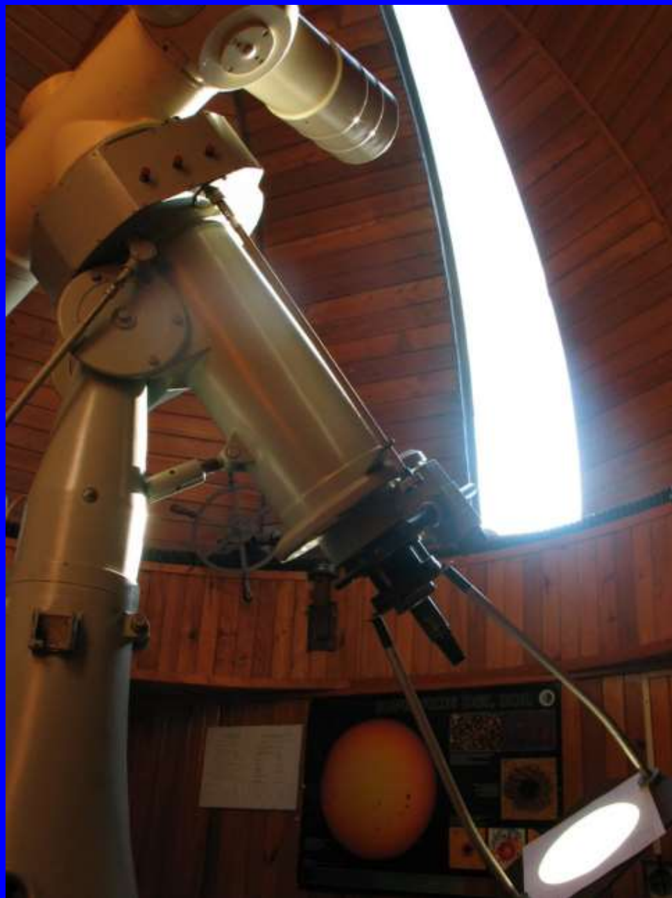
Refraktor Coudé, D/f - 15/225 cm, zakresľovanie slnečných škvŕn.
