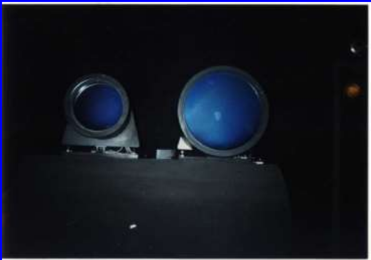
Kolimátorové zrkadlo (vľavo) a objektív spektrografu (vpravo)
