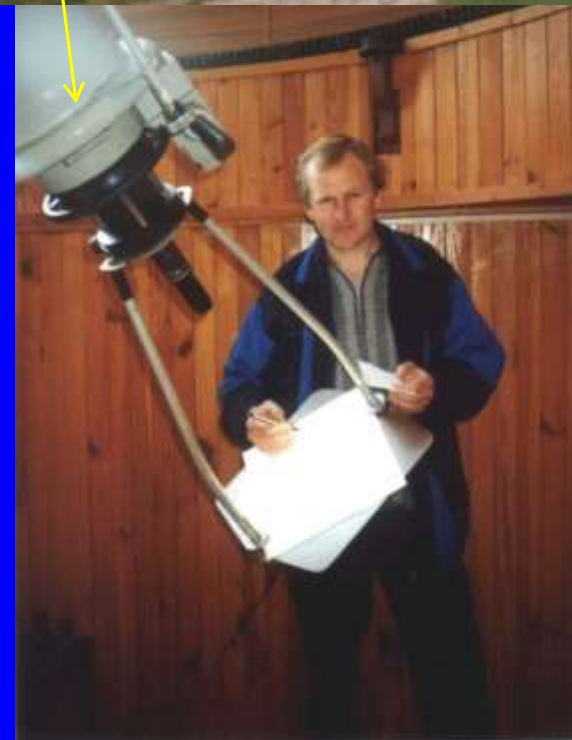
Refraktor Coudé, D/f - 15/225 cm, zakresľovanie slnečných škvŕn.
