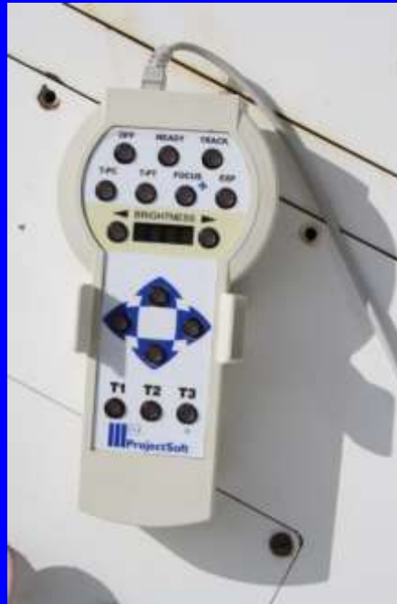
Ovládanie pohybu zrkadiel coelostatu
