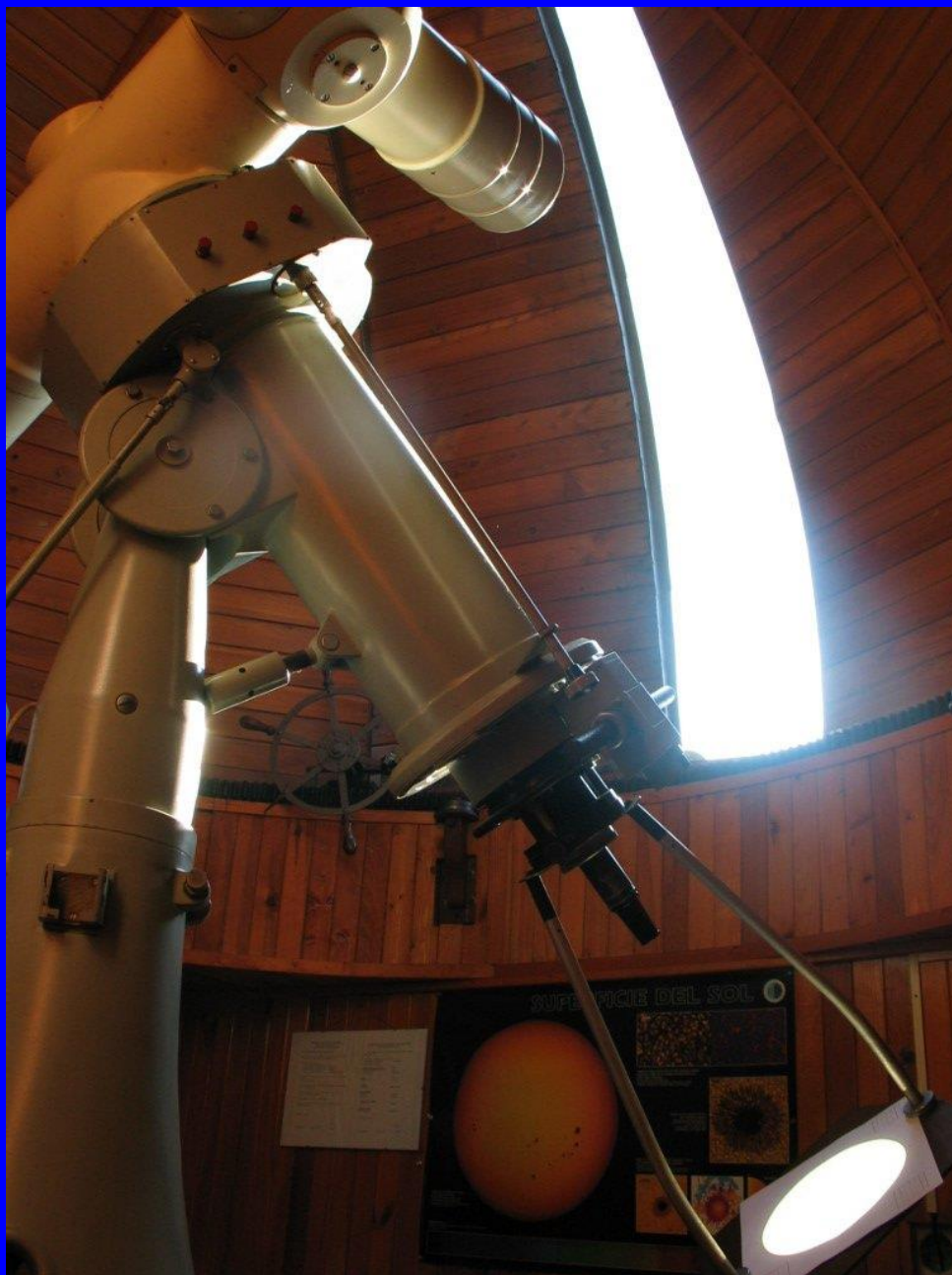
Refraktor Coudé, D/f - 15/225 cm, zakresľovanie slnečných škvŕn.
