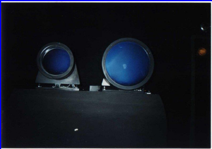
Kolimátorové zrkadlo (vľavo) a objektív spektrografu (vpravo)
