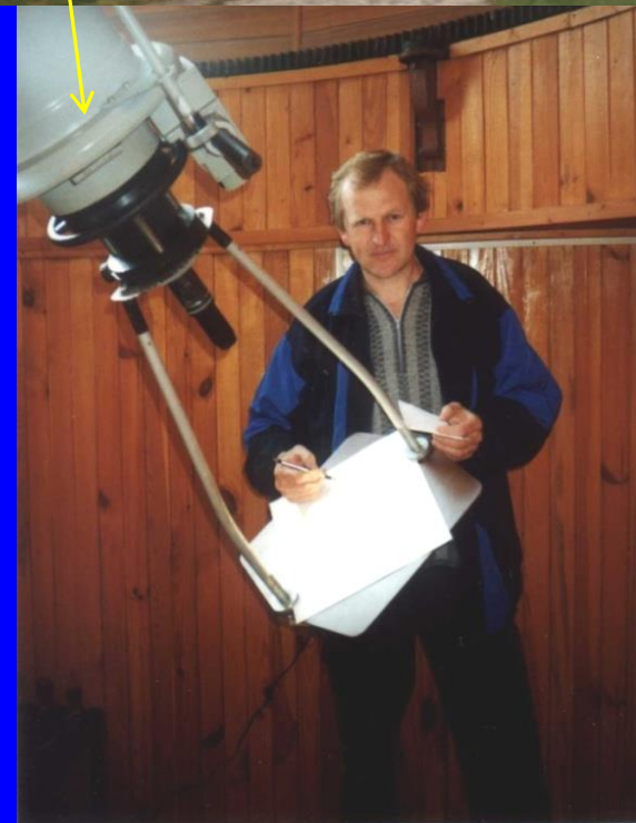
Refraktor Coudé, D/f - 15/225 cm, zakresľovanie slnečných škvŕn.
