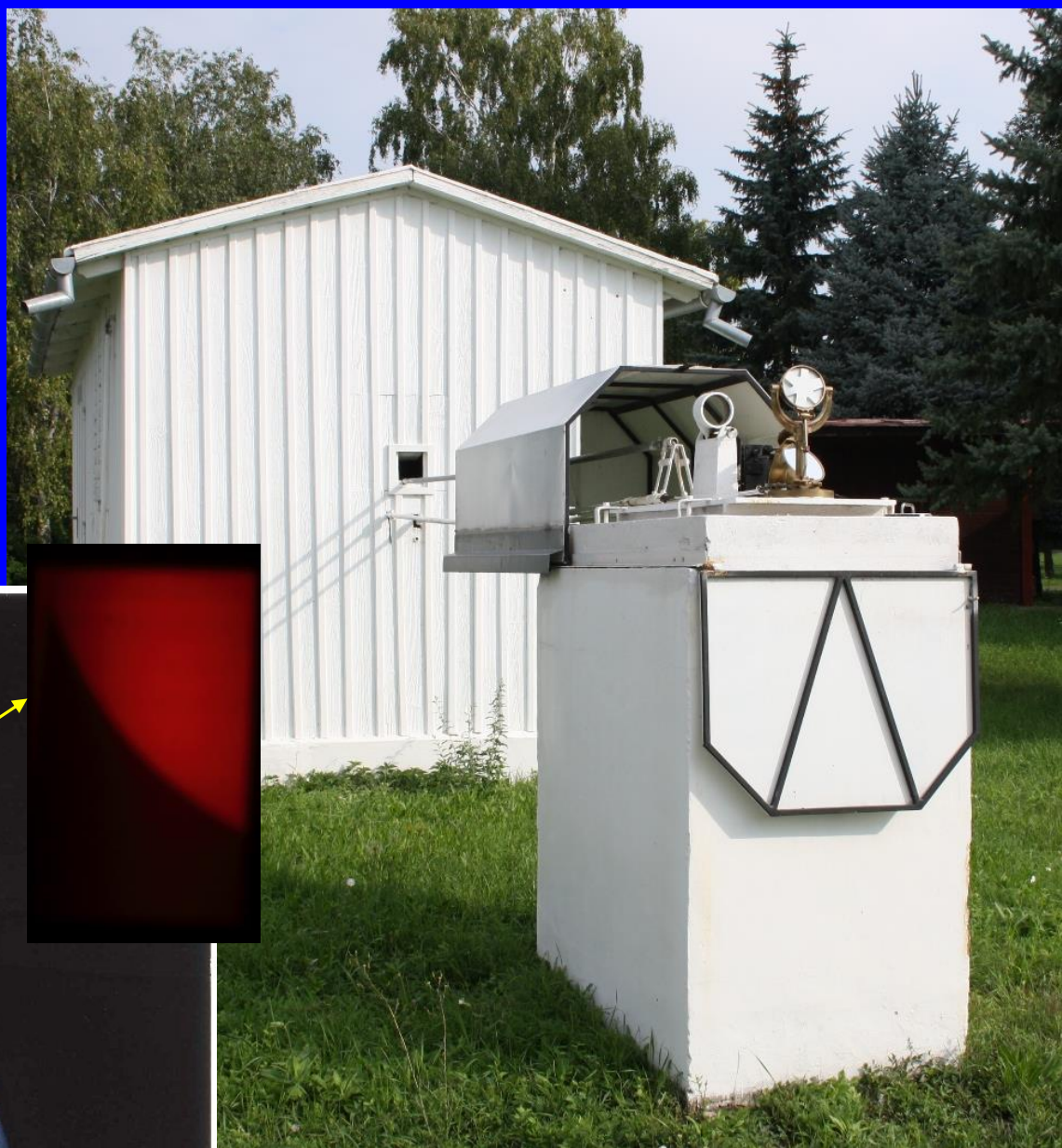
Spektrohelioskop, vizuálne pozorovanie erupcií
